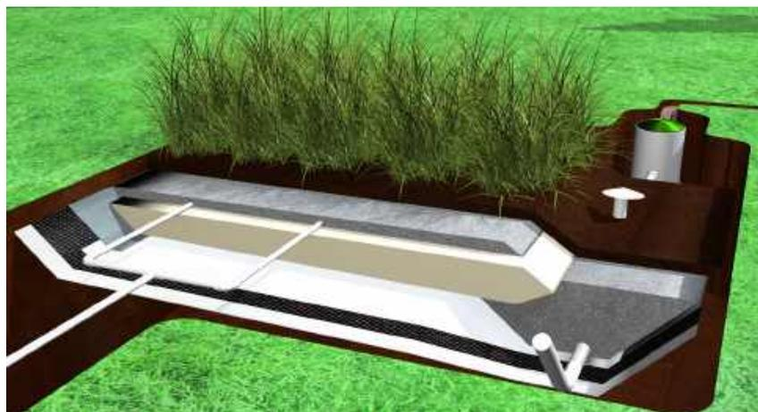
En plus de sa « filtre à sable surélevé » Tertre, Flexirub propose une gamme de kits modulaires prêts à poser (ici, le schéma d'un filtre à roseaux autoépuration agrégé) affichant un compromis entre qualité, simplicité d'installation et respect de l'environnement.
