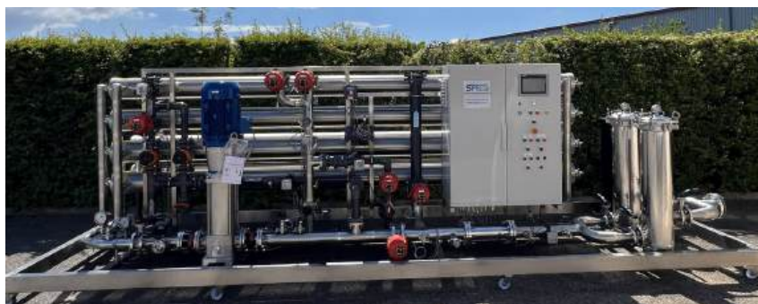
Le traitement de l'eau est désormais intégré comme un procédé stratégique à part entière (ici, un osmoseur de SFEC, destiné à un industriel des cosmétiques), impliquant davantage les équipes qualité, maintenance et environnement dès la phase de conception.
