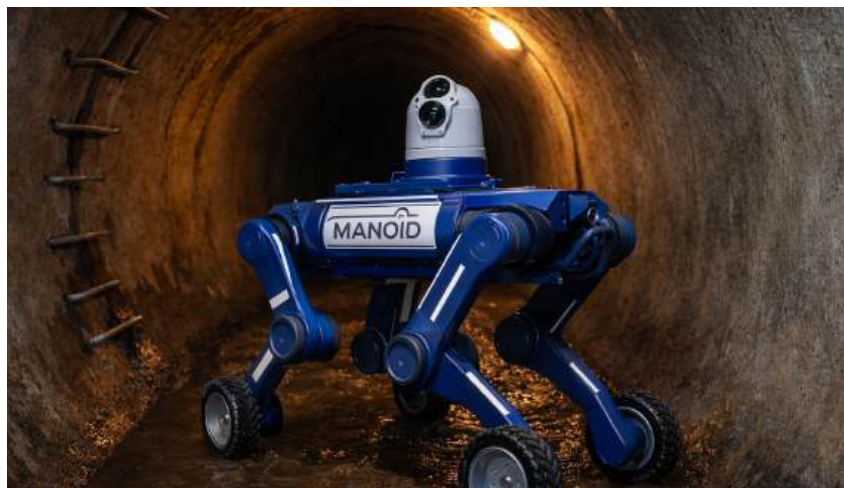
Les solutions robotisées agiles telles que les modèles Manoid de Duxogroup sont capables d'évoluer dans des canalisations d'un diamètre à partir de 500 mm.
