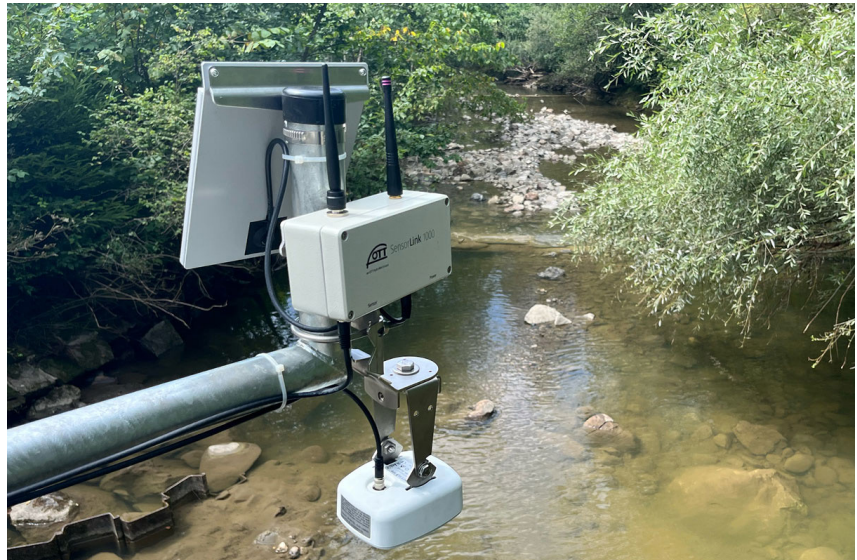
L'approche intégrée d'OTT France prend, notamment, la forme des stations radar OTT FMS regroupent capteurs, alimentation autonome et moyens de communication dans un équipement compact.
