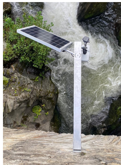
vorteX-io propose une station de mesure autonome et connectée, capable de mesurer simultanément plusieurs paramètres (hauteur d'eau, vitesse de surface, débit...).
