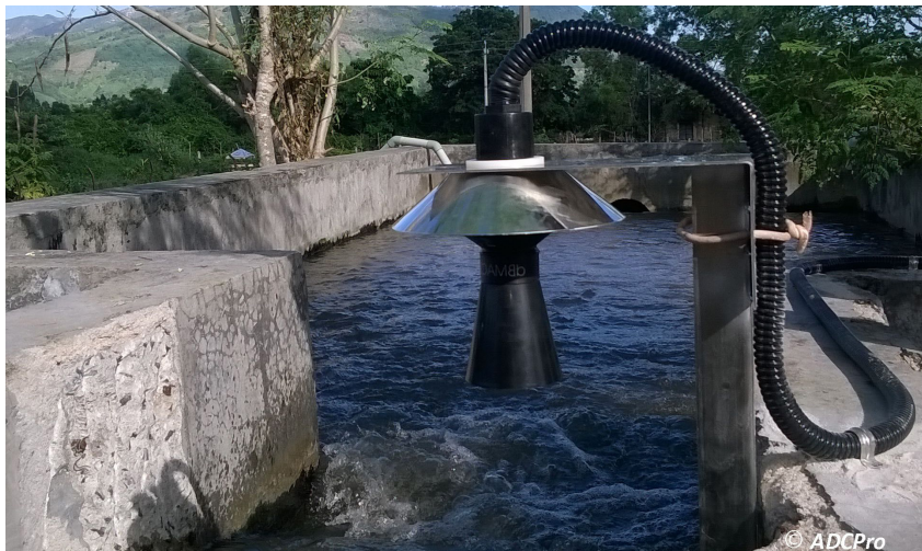
Le choix d'une solution dépend d'abord de la largeur, du marnage, de la profondeur d'eau, ou encore de la morphologie du terrain, chaque technologie (ici, un capteur de niveau à ultrasons Mach U) ayant ses avantages et ses limites.
