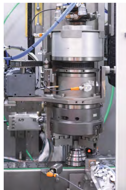
Chez ifm electronic, des outils d'IA sont intégrés afin de prédire la durée de vie des capteurs (ici, un capteur de vibrations VVB3 pour la surveillance d'une broche), etc.
