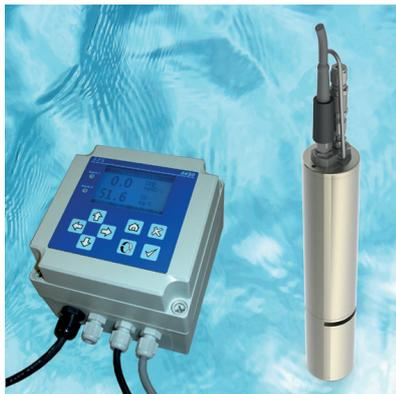
L'**UV-Probe 254+** est une sonde d'autosurveillance et mesure en ligne multi-paramètres destinée au contrôle en continu de la qualité des eaux et également pour la gestion des effluents. Le système est constitué d'une sonde de mesure en inox, d'un transmetteur assurant la collecte, le traitement et le renvoi des données.
