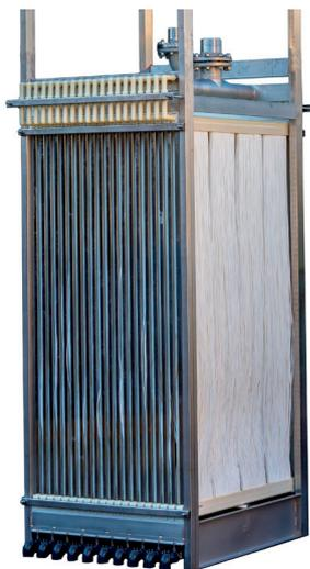
Les modules IMMEM® à membranes fibres creuses supportées sont composés d'une gaine textile en polyester très résistante mécaniquement, enduite du matériau membranaire Neophil® pénétrant profondément la tresse textile. La taille des pores de cette membrane est de 20 nm: ce sont de véritables membranes d'Ultrafiltration permettant un abattement des bactéries (6 log) et des virus (4log).
