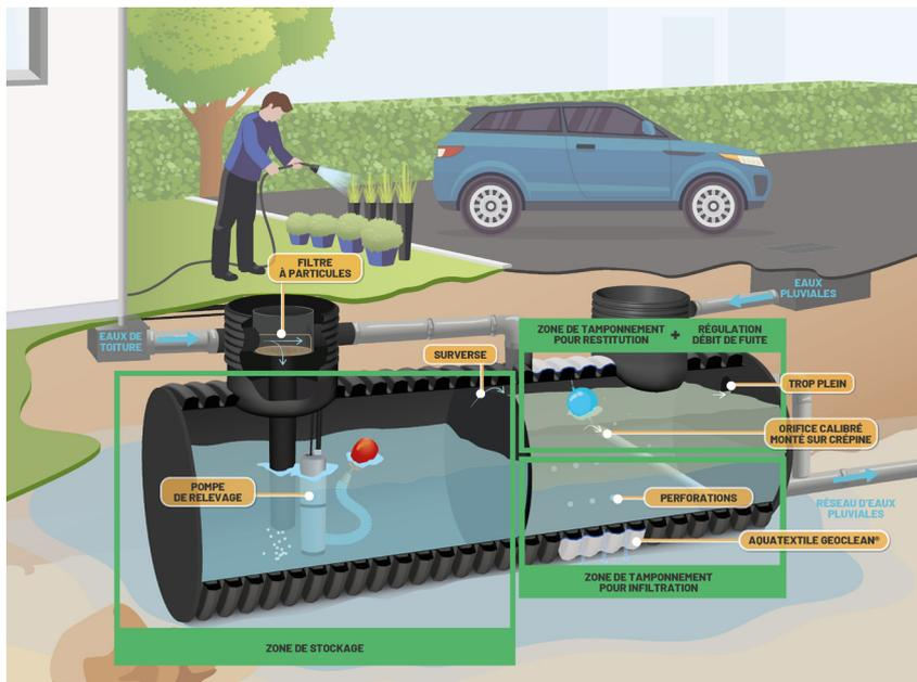
Le TAMP'EAU Hybride est fabriqué à partir de tube annelé PEHD SN8 sur lequel est soudé l'ensemble des pièces nécessaires au fonctionnement de la cuve. La particularité de TAMP'EAU hybride est d'associer sur un seul élément, quatre fonctions différentes: stockage, tamponnement, infiltration propre et régulation.
