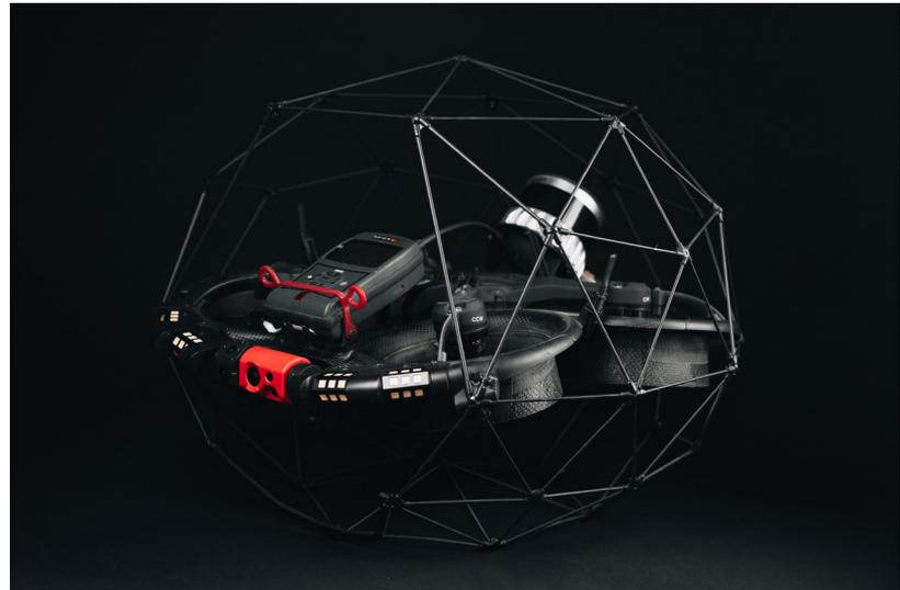
pour localiser précisément les sources de radiation. De plus, l'Elios 3 RAD est équipé d'un capteur détachable, ce qui permet aux travaux de continuer sans interruption lors de la maintenance et de la calibration du capteur.
