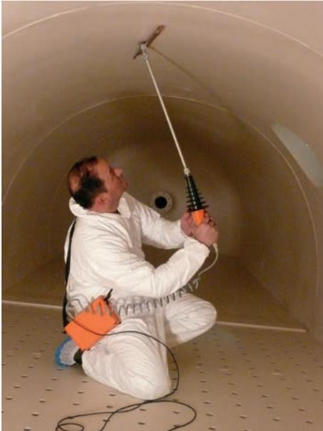
**Test au porosimètre du revêtement intérieur.**
