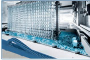
agents chimiques présente un autre avantage: les deux éléments glissent parfaitement l'un sur l'autre. Le faible poids de la goulotte et sa structure modulaire en facilitent nettement le montage.
