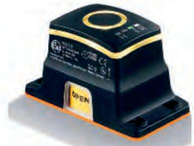
Le détecteur intelligent pour vannes ¼ de tour MVQ d'ifm electronic permet de configurer les fonctions nécessaires à l'application par logiciel de paramétrage (LR Device) ou par un bouton-poussoir inductif (fonctions de base). Les positions finales de la vanne peuvent être apprises librement et la tolérance de détection peut être ajustée.
