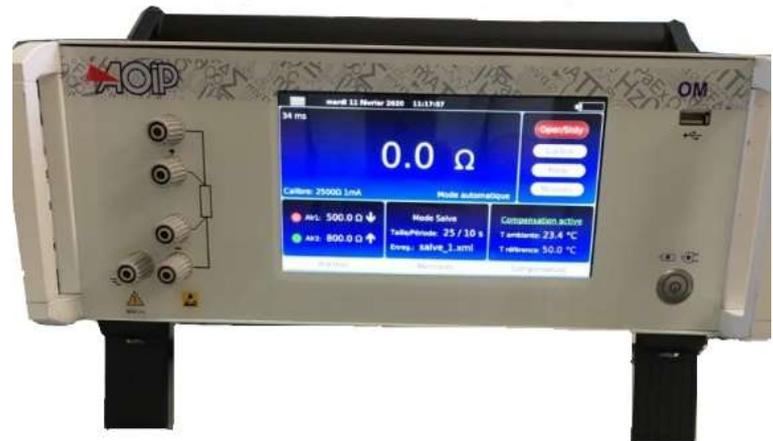
Conçu pour une utilisation sur site -en atelier, sur plate-forme ou à l'extérieur-, le micro-ohmmètre OM 27 construit dans un boîtier métal robuste et léger, est doté d'un écran tactile couleur simplifiant son utilisation
